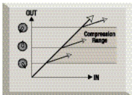
La cantidad en que el compresor reduce la ganancia viene determinado por el “ratio”. El ratio se expresa convencionalmente con un valor numérico, p. ej. “4:1”, que representa la cantidad en que se reducirá la ganancia cuando el volumen de la señal supere el threshold.
