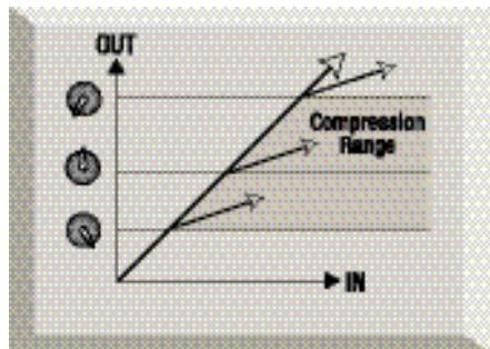
La quantità di riduzione è determinata dal parametro RATIO. Questo è convenzionalmente espresso in valori numerici, per esempio "4:1", che indicano di quanto verrà ridotto il guadagno quando il volume del segnale oltrepasserà la soglia.
