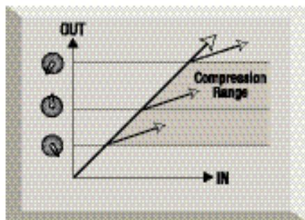
Le niveau de l'atténuation appliquée par le compresseur est déterminé par le taux. Le taux est exprimé sous forme de rapport, par exemple 4:1, qui représente la valeur de la réduction de gain lorsque le niveau du signal franchit le seuil.
