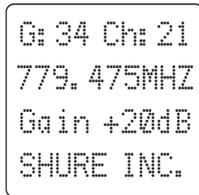
**Groupe (G) et canal (Ch).** Doivent correspondre aux paramètres du récepteur.
