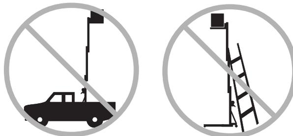
Ne pas placer d'échelle, ni d'échafaudage contre une partie de la machine.
