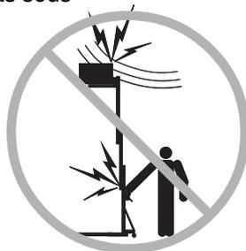
Maintenir une distance de sécurité par rapport aux lignes et aux appareils électriques, conformément aux réglementations officielles en vigueur et au tableau suivant.
