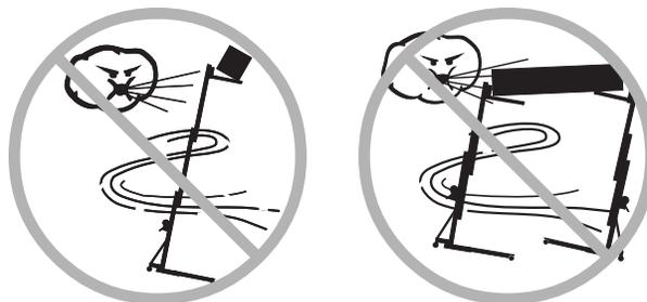
Ne pas laisser de charge surélevée en cas de risque de vent, à moins que la machine ne soit correctement haubanée.
