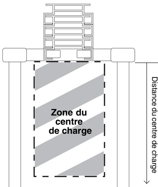
**Centre de gravité de la charge maximal**
