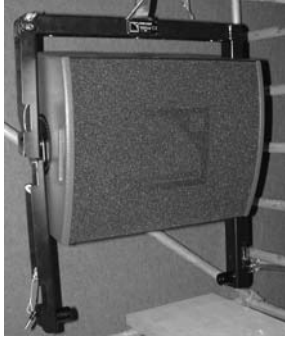
(3) Installer la première I12XT. Vérifier que le bras pivotant de l'ETR I12XT est sécurisé par la goupille située au point de pivot.
