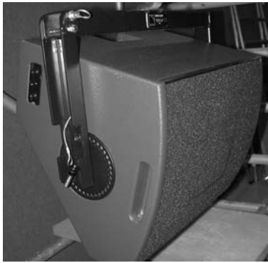
(9) Mettre en position le bras rotatif. La goupille sécurise automatiquement l'étrier.
