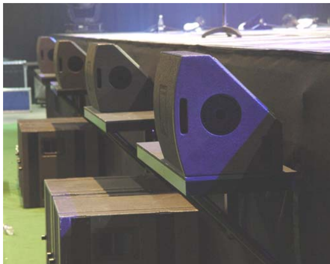
FIGURE 26: EXEMPLE DE SYSTEME DISTRIBUE « NEZ DE SCENE » EN 112XT
