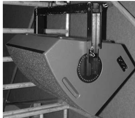
(10) Sélectionner l'angle et sécuriser l'ensemble à l'aide des deux goupilles à attache rapide.
