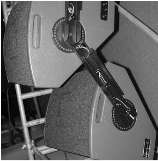
(9) Libérer les goupilles inférieures du I12XT afin de régler l'angle de l'enceinte inférieure après avoir réglé et verrouillé le premier I12XT sur le CPLI12XT.
