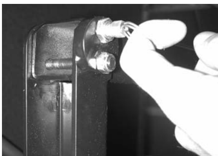
(5) Débloquent le bras pivotant à l'aide de la goupille.
