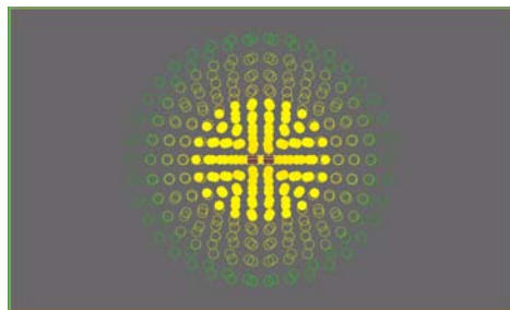
FIGURE 22: : CARTOGRAPHIES DE PRESSION SONORE CENTRES SUR UNE OCTAVE POUR DEUX ENCEINTES I 12XT, AVEC UN ESPACEMENT NON OPTIMAL
