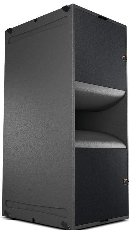
Le KS28 est un renfort de grave de référence conçu pour étendre la réponse en fréquence des systèmes grand format. Il comporte deux transducteurs à radiation directe de 18" haute excursion, montés dans une enceinte bass-reflex. Les L-Vents réduisent le bruit de turbulence et de port aux niveaux élevés tout en augmentant l'efficacité des basses fréquences (LF).
